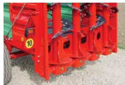
A szórószerkezet zárt, olajjal töltött hajtóműve
