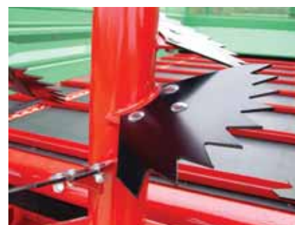
Egyszerűen leszerelhető HARDOX kések
