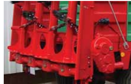
A szórószerkezet zárt, olajjal töltött hajtóműve
