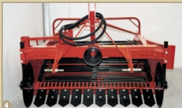
3 - Vista posteriore SP-2 con griglia posteriore oscillante e rullo compattatore tra le ruote. Vue depuis l'arrière SP-2 avec grille arrière oscillante et rouleau compacteur entre les roues. Rear view of SP-2 with rear swinging reel and compacting roller between the share blades Hintere Ansicht des SP-2 mit hinterem schwingendem Rost und Dammandruckwalze zwischen den Rädern.
