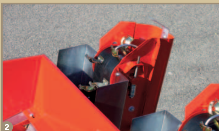
1 - Assolcatore fisso regolabile in altezza. Soc fixe avec hauteur réglable. Fixe furrow with adjustable height
