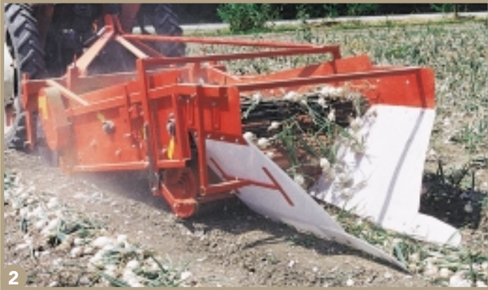
1 - Vista anteriore OD al lavoro con dischi tagliaerba (opt.) - Rullo estrattore quadrato e ruote di livello. Vue de face OD au travail avec disques (opt.) - rotor d'arrachage carré et roues de niveau. Front view of OD at work with grass-cutting discs (opt.) - Square extraction roller and level wheels. Vorderansicht OD bei der Arbeit mit Scheibenseche (opt.) - Vierkantrödwelle und Tiefenführungsräder
