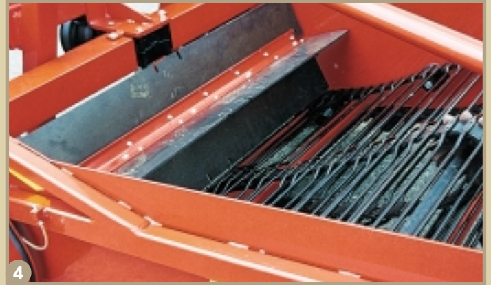
3 - Particolare fiancata sinistra OD con manovella di comando, agitatori ad intensità regolabile sul 2° nastro. Détail côté gauche OD avec manivelle de commande. Secoueurs à intensité réglable sur la 2 e chaîne. Detail of left side of OD with adjustable intensity agitator control crank on 2nd belt Besonderheit der linken Seite des OD mit Befehlsspindel - Regulierbarer Dreiecksschüttler im zweiten Siebband
