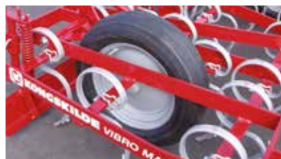
A 165x15" gumikerek alapfel-szerelés a SQ típusokon. A 6.00x12" gumikerek az SGC típus alapfelszerelése.
