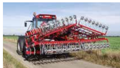
Az oldalszárnyak szállítási helyzetben a főkeretre csukódnak rá.
