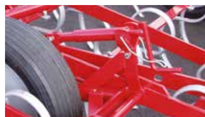
A kerek mélységállítása skálán leolvasható.
