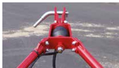
Gumibak a traktor és az eszköz kímélésére.
