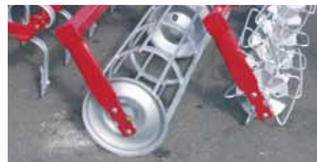
Munka közben a hengerek gondoskodnak a gép pontos helyzettartásáról.
