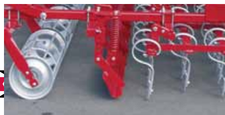
A simító lapok magassága és szögállása állítható.
