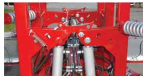
Automatikus hidraulikus szárnyreteszelés
