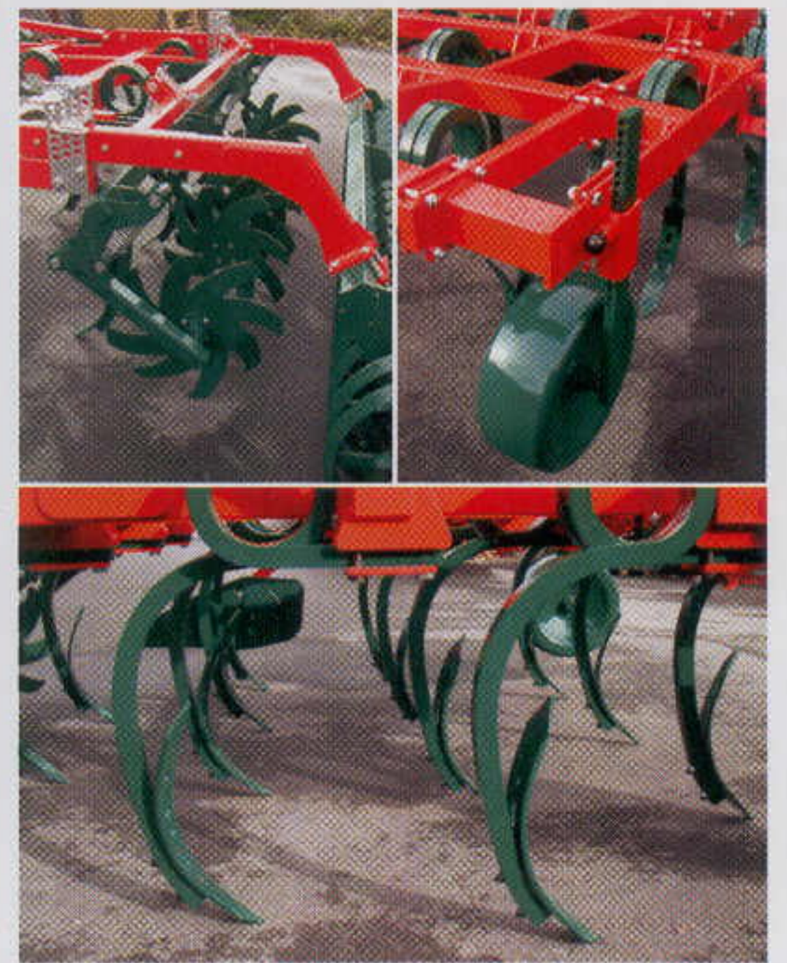
Szinttartó tárcsaszor (bal fent), támkerék (jobb fent) és a rugós fogak (lent) teszik a VN TerraCult-ot csúcsmodellé
