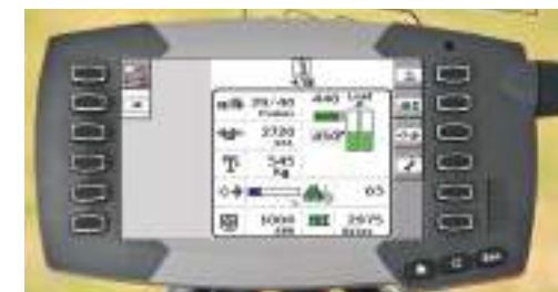
Automatikus tömörségszabályozás a C1000 bálázó monitor által
