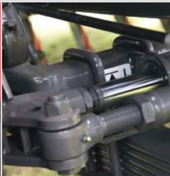
Hátsó tengely kormány szerkezet hidraulikus reteszelése
