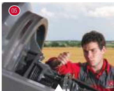
05 A lendkerék súrlódó tengelykapcsolójának beállítása
