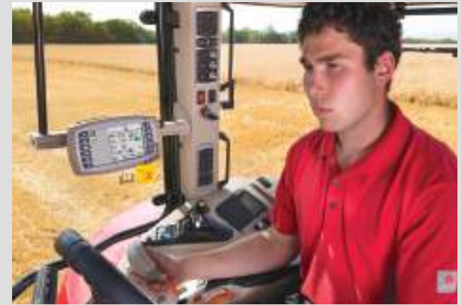
A bálázó a traktor ISO VT csatlakozóján keresztül irányítható.
