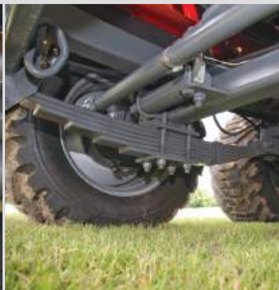
Független laprugók mindegyik keréknél
