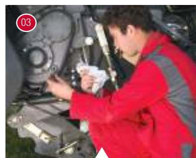
03 Az olajsint ellenőrzése az aprítószerkezet hajtóművében
