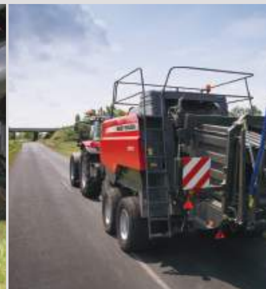
A kettős futómű nagy sebességet tesz lehetővé a közúti közlekedés során, és kiemelkedő kényelmet biztosít táblaváltáskor.
