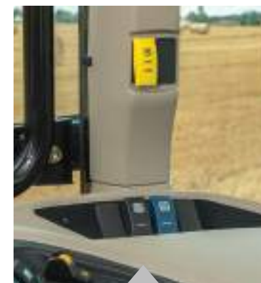
Új 100 liter/perc 'kombinált' áramlás egy gombnyomásra
