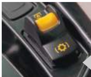
A teljesítményleadó tengely összekapcsolása ugyanúgy elektropneumatikus és 3 pozíciós biztonsági kapcsolóval működtethető (be, ki és zár/fék).
