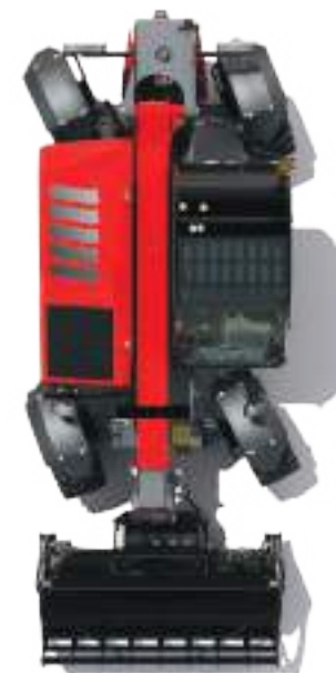
Oldalazó kormányzási mód - a hatékony töltési és talajjenyetési műveletekhez, valamint a falak mellett és szűk térben történő munkavégzéshez.
