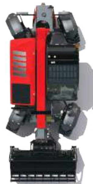
Négykerék-kormányzási mód - a minimális fordulókör érdekében.
