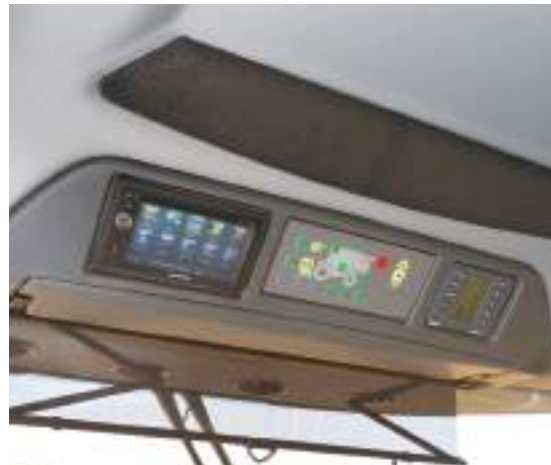
Világításvezérlő panel, CD-, DVD-lejátszót, USB-portokat, navigációt és Bluetooth rendszert is tartalmazó médiarendszer (opcionális), légkondicionáló
