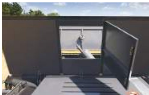
A magtartály rendkívül egyszerűen hozzáférhető a motortérből, ha tisztításra vagy ellenőrzésre van szükség.
