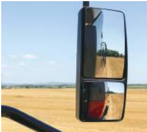
Kiváló rálátás a gép oldalára a két részből álló tükröknek köszönhetően.
