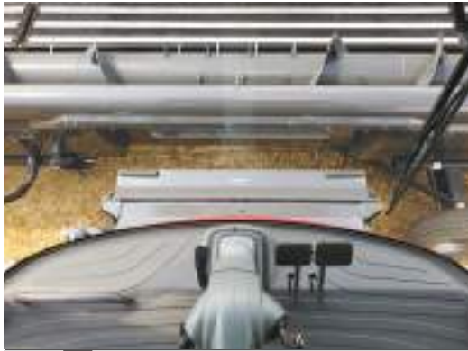
Tiszta rálátás a vágóasztal csatlakoztatásához a gyors le- és felszerelés érdekében
