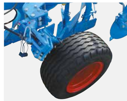
Hidraulikus mélységátároló és szállító kerék
