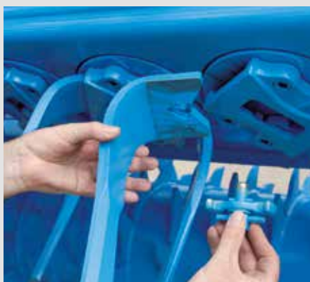
A fogak cseréje a gyorscserélő rendszer segítségével
