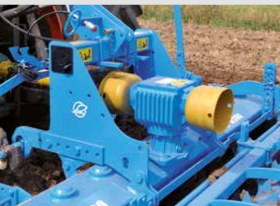
Egyszerű erőátvitel a cserekeres hajtóművel
