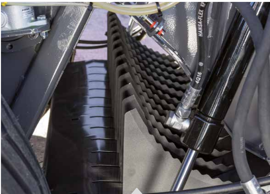
Az MF RB 3130F felszerelhető 13, 17 vagy 25 kést tartalmazó Xtracut berendezéssel.
