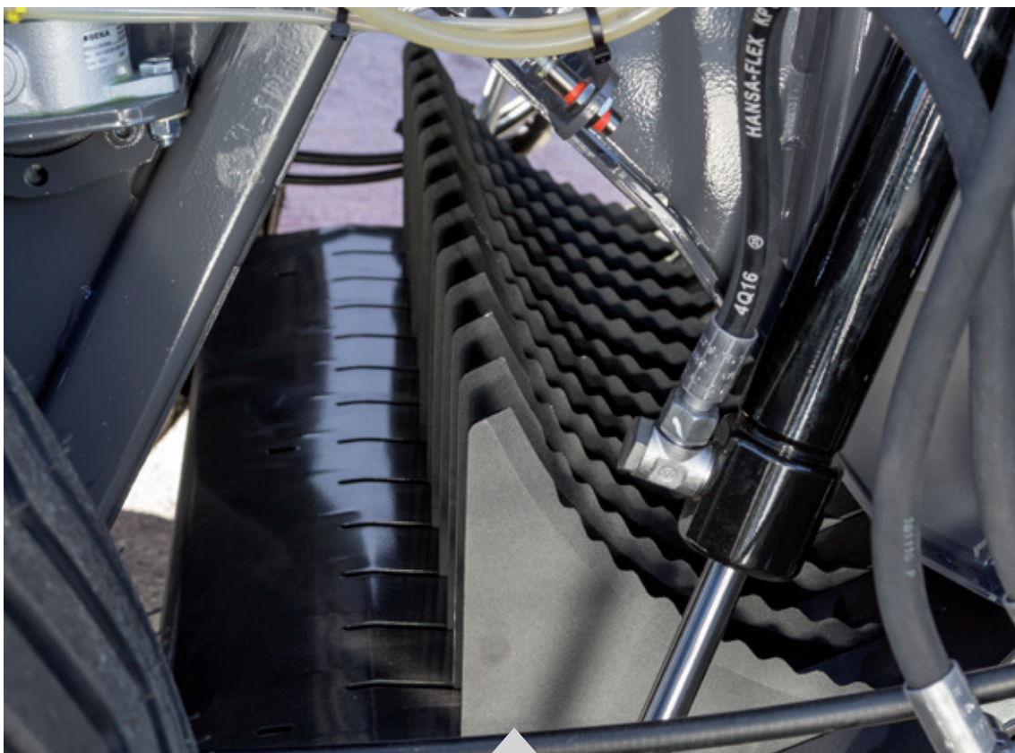
Xtracut 13 rotor 90 mm-es elméleti szecskahosszal
