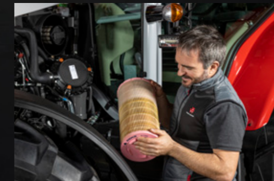
A motor légszűrője könnyen hozzáférhető és tisztítható.
